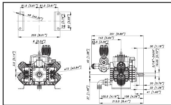
**DE****Versione con albero cavo Dia.19 per l'accoppiamento a motori elettrici IEC 80 B14-19mm**
