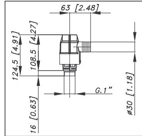
**Valvola di sicurezza** - Safety valve - Предохранительный клапан
