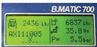
n. 2 Schermate di lavoro che visualizzano: dimensioni goccia, liquido rimanente, sezioni aperte, bar, l/min, velocità, l/ha, ....
