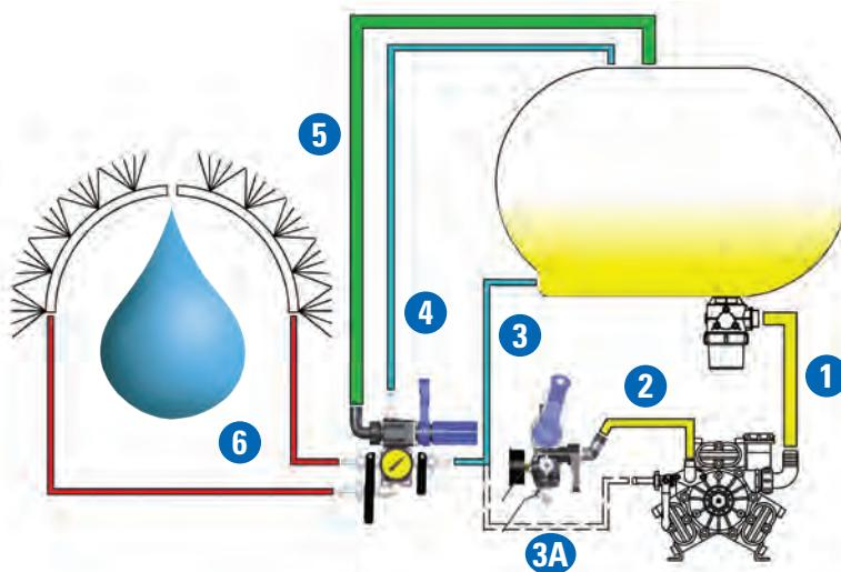
линия перемешивания с правильно подобранный форсункой (в зависимости от давления, расхода насоса, потока через форсунки), подсоединяется непосредственно к дополнительному выходу насоса, либо к одному из выходов Sting Plus (работает только когда регулятор под давлением). См. схему стр.114 (Гидроперемешиватели Бертолини).
