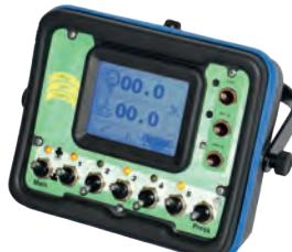
Stesse caratteristiche e funzionalità della versione "Eco", ma con l'aggiunta di tre interruttori supplementari per l'azionamento di componenti elettrici della macchina (es.: Valvole per agitazione, valvole per caricamento, attuatori per movimentazione paratie e settori, luci, ecc.)
