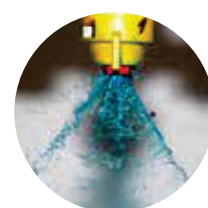
C Daño debido a la limpieza incorrecta
