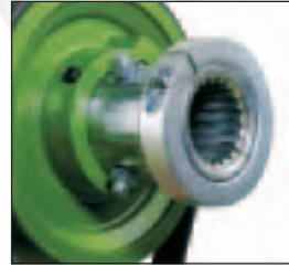
Eje de 1 3/4" (44,5 MM) de diámetro interior dividido de 20 estrías con dispositivo corredizo para los modelos de 1000 RPM
