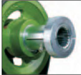
Eje de 1 3/8" (34,9 MM) de 21 estrías con dispositivo corredizo, para los modelos de 1000 RPM
